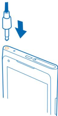
Ne connectez pas de produit créant un signal de sortie, car cela pourrait endommager l'appareil. Ne raccordez aucune source de tension au connecteur audio. Si vous connectez au connecteur audio un appareil externe ou un kit oreillette autre que ceux dont l'utilisation avec cet appareil a été agréée, faites particulièrement attention au niveau du volume.
