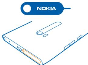
Le téléphone doit être hors tension avant d'insérer la carte SIM.
